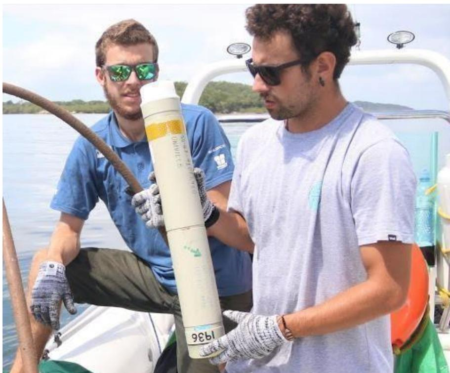
Figura 5 - Pesquisador do Projeto Toninhas, em 2018, manuseando um C-POD, dispositivo autônomo para registro de sons de alta frequência. Fonte: Projeto Toninhas/Univille.
